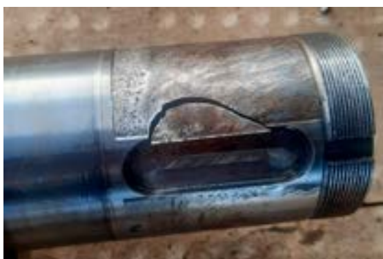
Vue du dégât sur l'arbre du train de pignon 2.
