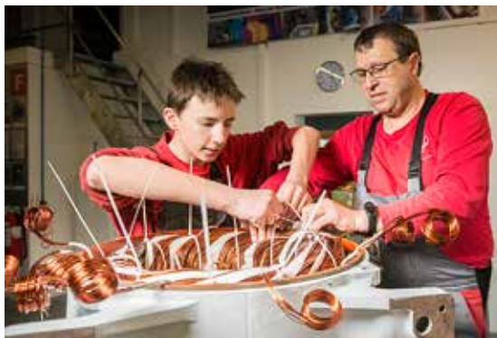
Valélectric réalise des bobinages de petits moteurs électriques jusqu'à des machines de 800kW.
